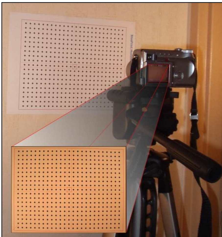
Zdjęcie 1. Przykładowy sposób pomiaru planszy kalibracyjnej
